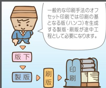
一般的な印刷手法のオフセット印刷では印刷の基となる版(ハンコ)を生成する製版・刷版が途中工程として必要になります。
